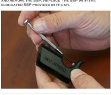
STEP 2 - BACK OUT THE TEFLON SCREW ON THE TICK USING A SMALL, FLAT BLADED, SCREWDRIVER, OR SIMILAR INSTRUMENT/TOOL
